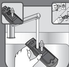
**PT** Encha o depósito da água com 100% de água e repita a operação até que o depósito da água fique completamente vazio, de modo a lavar o aparelho.
