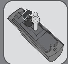
**FR** Ouvrez le bouchon du réservoir d'eau.
