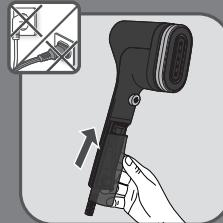
**FR** Replacez le réservoir d'eau en position en le faisant glisser jusqu'à ce qu'il soit complètement enclenché. Assurez-vous que le réservoir d'eau est complètement mis en position.
