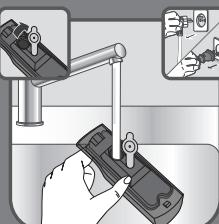
**FR** Remplissez le réservoir d'eau avec 100% d'eau et répétez l'opération jusqu'à ce que le réservoir d'eau soit complètement vide afin de rincer l'appareil.
