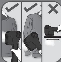
**FR** Pour une utilisation optimale, passez l'appareil et les jets de vapeur sur votre vêtement de haut en bas en position verticale, avec un angle de 30 ou 90 degrés, mais jamais en position horizontale.
