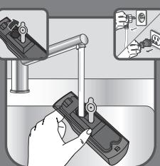
**NL** Vul het waterreservoir met 100% water en herhaal de procedure totdat het waterreservoir compleet leeg is om het apparaat te reinigen.
