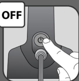
**NL** Druk op de aan-/uit-knop en houd hem 3 seconden ingedrukt om het apparaat uit te schakelen.
