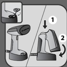
**NL** Voor de opslag of om hem in het reistasje op te bergen, kunt u het apparaat inklappen. Druk altijd op de ontgrendelingsknop voor de kop alvorens de kop in te klappen.
