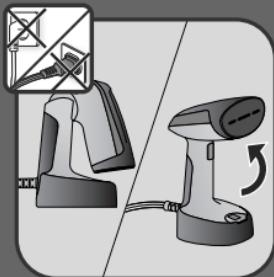
**NL** Klap de stoomkop altijd uit totdat hij is vergrendeld voordat u het apparaat gebruikt.
