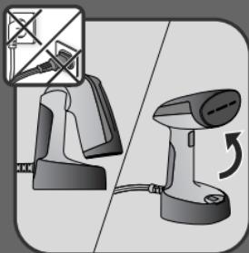
**ES** Antes de utilizar el aparato, despliegue siempre el cabezal de vapor hasta quedar acoplado.
