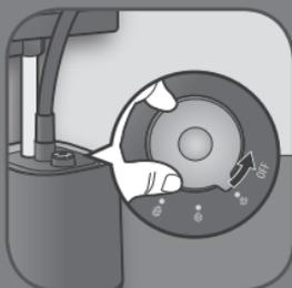
**CZ** Zařízení vypněte otočením hlavního vypínače do polohy „OFF“ (VYP).
