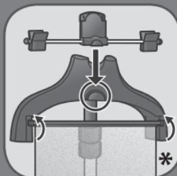
**CZ** Přidejte vertikální podporu a ramínko.
