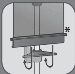
**CZ** Odviňte podpěru, upevněte nastavením pnutí pomocí určeného háčku a zajistěte ji.
