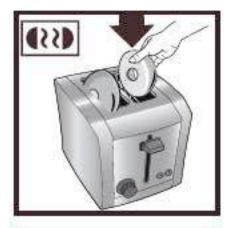
Pour griller un bagel à l'intérieur et le chauffer à l'extérieur, utilisez la touche «Bagel».
