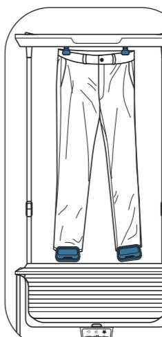
Hängen Sie Ihre Hose mit den integrierten Klammern im Care For You auf. Zum Dämpfgleiten platzieren Sie eine kleine Klammer am Ende jedes Hosenbeines.
