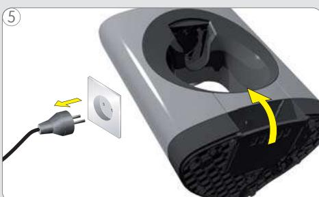
Odpojte přístroj ze zásuvky. Nakloněním přístroje se jednodušeji dostanete k tryisce.
