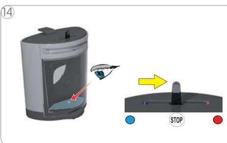
Vizuálně zkонтrolujte, zda je zásobník vody prázdný. Volicí páku posuňte do polohy „STOP“.
