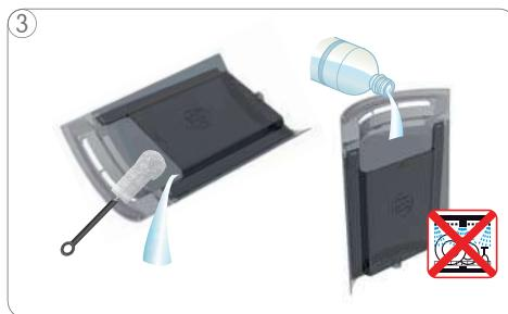
Vypláchněte a vyčistěte zásobník vody. Následně jej napříte čistou pitnou vodou a vložte jej do přístroje. Zásobník vody není možné mýt v myčce nádobí!
