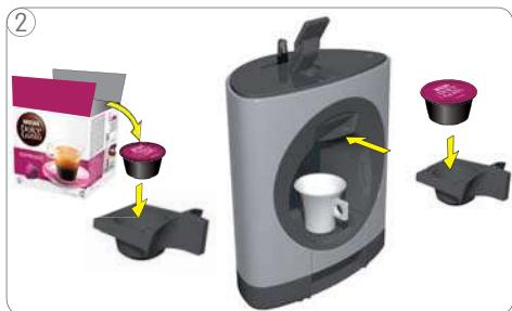
Do držáku kapslí vložte novou kapsli a nasaděte jej zpět do přístroje.
