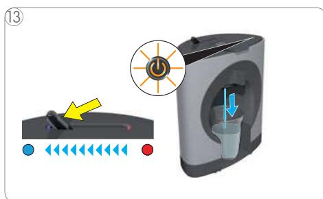
Volicí páku posuňte do polohy „STUDENÁ“. Přístroj spustí vyplachování, vypínač bliká oranžově.
