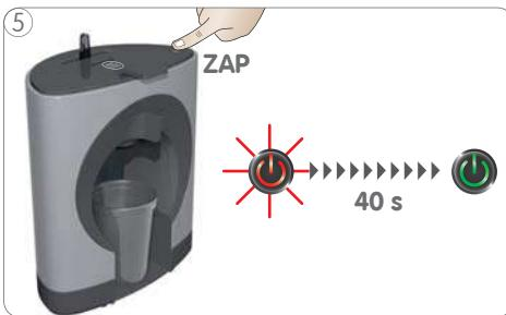
Zapněte přístroj. Během zahřívání přístroje (přibližně po dobu 40 sekund) začne vypínač červeně blikat. Poté, co se vypínač rozsvítí zeleně, je přístroj připraven k použití.
