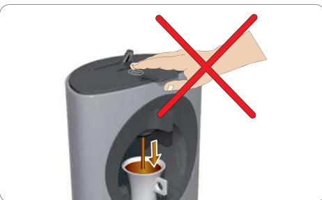
⚠️ Nikdy neotevříte zavírací páku v průběhu přípravy nápoje!
