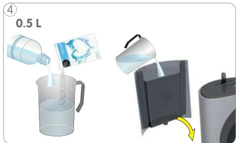
Do 0,5 litru vody v nádobě namíchejte obsah odvápněvacího sáčku. Odvápněvací roztok nalije do zásobníku vody a zásobník vložte do přístroje.
