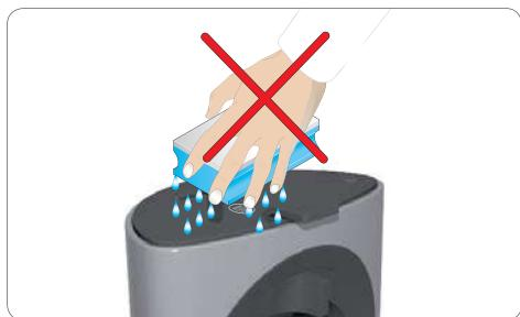
⚠️ Nikdy nepoužívejte mokrou houbičku. K očištění povrchu přístroje používejte pouze měkkou vlhkou utěrku.
