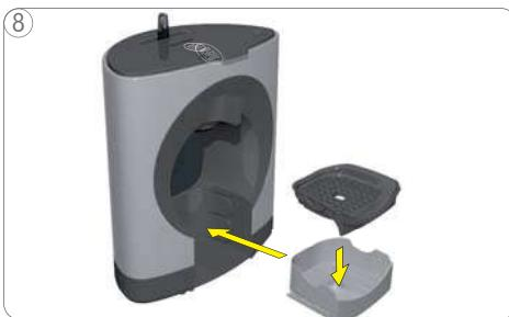
Odkapávací mřížku umístěte na odkapávací tácek. Poté vložte odkapávací tácek na požadovanou pozici na přístroji.
