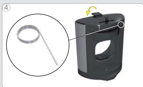
Vyjměte zásobník vody a čisticí jehlu. Zavřete zavírací páku. Vyjměte odkapávací tácek.
