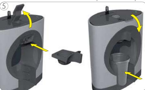
Otevřete zavírací páku a vložte prázdný držák kapslí. Slaťte aretační páčku směrem dolů. Umístěte litrovou nádobu pod trysku kávovaru.
