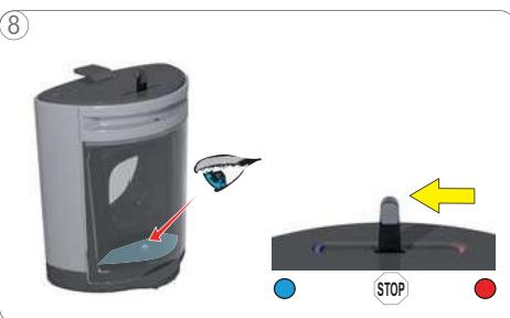
Po vyprázdnění zásobníku vody posuňte volící páku do polohy „STOP“.
