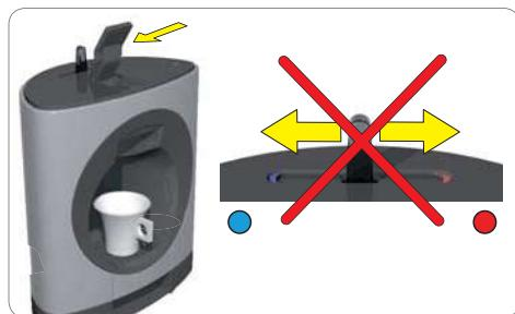
⚠️ Volicí páku nikdy neposunujte, pokud je zavírací páka otevřená!
