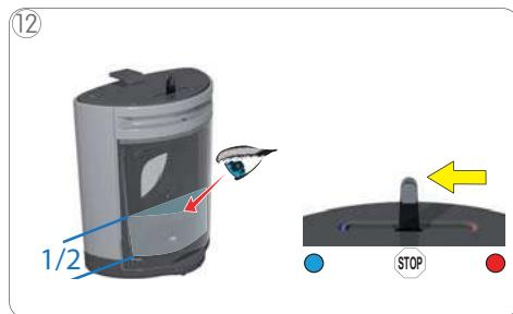
Vizuálně zkонтrolujte, zda je zásobník vody zpola plný. Volicí páku posuňte do polohy „STOP“.
