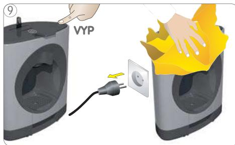
Vypněte přístroj. Odpojte přístroj ze zásuvky. Stroj vyčistěte měkkou vlhkou utěrkou. Poté jej vysušte měkkou suchou utěrkou.
