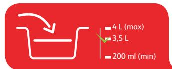
N.B. pour une volume max. de 4 litres et min. de 200 ml pour cuisson rapide.
