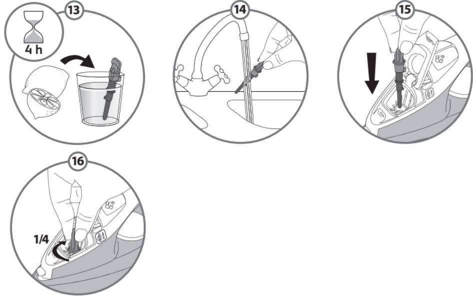
\*FR Nettoyage de la tige anti calcaire (une fois par mois) • KO 를 때 제거 밸브 세척하기(한 달에 한 번) • TH การทำความสะอาดด้วยดักตะกรัน (เดือนละครั้ง) • AR مرتاديّن لـ KO (مرة واحدة شهرياً) • FA پاک کردن سوپاپ ضد آهک (ماهی یکبار) • HK 清洗防鈣活門 (每月一次) • RC 清洗防钙阀门 (每月一次) • EL Καθαρισμός της αντιαλακαλικής βαλβίδας (1 φορά το μήνα)
