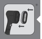
底面兩用墊\*其中一面採用柔軟的天鵝絨物料,可去除皺摺而不損壞衣物;另一面則配備除毛刷,可梳理紡織品表面以去除絨毛和毛髮。 裝卸清潔墊前\*,請先拔除裝置電源,並讓裝置冷卻 1 小時。
