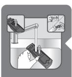
在水箱內倒入 100% 清水,然後重複操作,直至完全清空為止,藉以完成沖洗程序。
