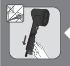
操作前將清潔墊\*拆除。向下滑動水箱,將其取出。
