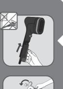
向上滑動水箱,將其裝回原位,直至完全裝妥。 確定水箱已完全裝妥。
