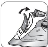
Tenez le fer à repasser en position oblique. Ouvrez l'orifice de remplissage. Versez de l'eau jusqu'au repère max. Fermez l'orifice de remplissage. Vous pouvez mettre le fer de nouveau à l'horizontal.
