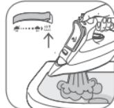
Mediante la función de autolimpieza se eliminan de la cámara de vapor restos de suciedad y residuos minerales.
