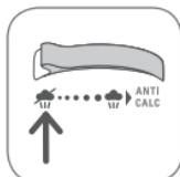
Girar el regulador de vapor a y ajustar la temperatura según el tipo de tejido (símbolos de puntos •, ••, •••).
