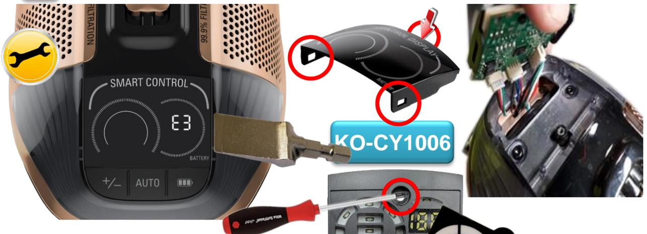
Avant de remplacer le moteur, vérifier la connexion sur la carte électronique et l'état des fils du faisceau du moteur. Pour ce faire, déclipser le cadran supérieur, ensuite décoller l'autocollant pour avoir accès à la vis de fixation de la carte électronique.
