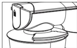
Включите прибор, повернув переключатель скорости на нужное значение от Min до Max. Инструкции по выбору скорости приводятся далее в этой брошюре. Не включайте кухонную машину, предварительно не загрузив ингредиенты в чашу. Придерживайтесь инструкций рецепта.
