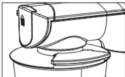
Setzen Sie das Gerät in Gang, indem Sie den Geschwindigkeitsregler auf die gewünschte Geschwindigkeitsstufe zwischen Min - Max einstellen. Anweisungen zur Wahl der Geschwindigkeit finden Sie weiter hinten in der Bedienungsanleitung. Stellen Sie vor dem Einschalten der Küchenmaschine immer sicher, dass sich Zutaten im Behälter befinden. Befolgen Sie die Anweisungen des Rezepts.
