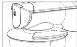
مواد را اضافه کنید. مراقب باشید تا از دستگاه لبریز نشود. دسته انتشار را فشار دهید تا از سر مخلوط کن پایین تر آورده شود و دست خود را بر روی سر مخلوط کن قرار دهید هنگامی که در کاسه پایین آورده می شود و به یک پرز برق متصل کنید. لاستیک آویخته را با محکم فشار دادن بر روی سر مخلوط کن بلند کنید بطوریکه حفره تغذیه مانند شکل زیر قرار داده شود:
