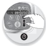
1 - Premere direttamente sul selettori del parametro che si è scelto di regolare, ovvero quello della velocità (B2), quello del selettore della temperatura di cottura (B3) o sul selettore del tempo (B4): il parametro scelto lampeggia sullo schermo (C1-C2-C3).
