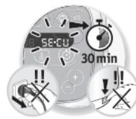
Ihr Gerät ist seriennmäßig mit elektronischen Motorschutzfunktionen ausgestattet, um seine Langlebigkeit zu gewährleisten. Diese
