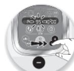
3- Regel de parameter(s) met behulp van de '+/-'-schakelaar (B6).
