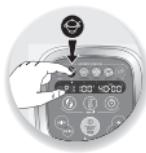
1- Premere sul programma scelto (**B1**): sullo schermo appare un triangolo (**C4**) sotto il programma selezionato. In caso di programmi di zuppe, cotture a fuoco lento e impasti, premendo di nuovo è possibile scorrere i vari sotto-programmi.
