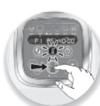
4- Una volta modificati tutti i parametri, premere il pulsante "start" (**B7**) per avviare il programma. Quando l'apparecchio è in modalità cottura, la spia luminosa rossa (**B3**) si accende per segnalare che la cottura è iniziata.
