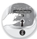
2- Le impostazioni preprogrammate possono essere modificate per una sola ricetta (in base ricetta scelta, gli ingredienti, le quantità). Premere sul selettore di velocità (**B2**), sul selettore della temperatura di cottura (**B3**) o sul selettore del tempo (**B4**): il parametro scelto lampeggia sullo schermo (**C1-C2-C3**).
