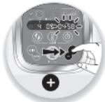
3. هنگام به پایان رساندن وارد کردن تمام پارامترها، دکمه "start" را فشار دهید. هنگامی که دستگاه از حالت پخت و پز استفاده می کند، چراغ نشانگر قرمز (B3) روشن می شود تا به شما اطلاع دهد که پخت و پز شروع شده است. وقتی برنامه شروع شد، شما با فشار بر دکمه "Stop" امکان توقف دستگاه را در هر زمان دارید.
