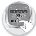
3 - Cuando haya terminado de ajustar todos sus parámetros, pulse el botón «start» (B7). Cuando su aparato utiliza el modo de cocción, el testigo luminoso rojo (B3) se enciende para informarle de que la cocción se ha iniciado. Cuando se inicia la programación, tiene la posibilidad de detener el aparato en cualquier momento pulsando el botón «stop».
