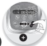
2 - A continuación, ajuste el (los) parámetro(s) con el selector +/- (B6). Por motivos de seguridad, no es posible ajustar una temperatura sin ajustar un tiempo de cocción.
