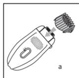
Mettez le peigne en place en le glissant dans les rainures (a), puis positionnez l'interrupteur sur 2.
