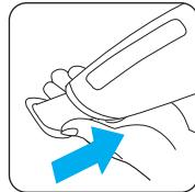
Para los líquidos sobre superficies lisas, coloque la boquilla para líquidos\* en la boca de aspiración.
