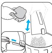
Vergessen Sie nicht den Behälter zu entleeren, falls Sie zuvor Wasser gesaugt haben.\* Trocknen Sie sorgfältig den Behälter und den Filter bevor Sie Staub saugen.
