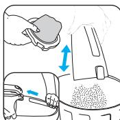
Удалите из пылесборника остатки воды, если до этого прибор использовался для всасывания жидкости.\* Перед уборкой пыли как следует высушите пылесборник и фильтр.
