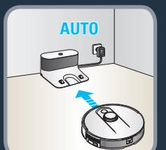
Kapcsolja be a robotot a Be- és kikapcsoló gomb nyomva tartásával, amíg a robotfények be nem kapcsolnak (kb. 5 másodperc). Helyezze el a robotot 20–50 cm-re az állomástól. Nyomja meg az Otthon gombot, és a robot automatikusan az állomásra dokkol. (Ne helyezze a robotot kézzel az állomáshoz.)
