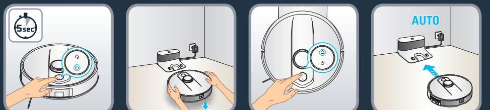
Zapněte robota stisknutím a přidržením tlačítka napájení, dokud se kontrolky robota nerozsvítí (asi 5 sekund). Umístěte robota 20 až 50 cm před stanicí. Po stisknutí tlačítka „Home“ (Domů) robot automaticky zadokuje do stanice. (Nikdy robota ke stanici neumísťujte ručně).
