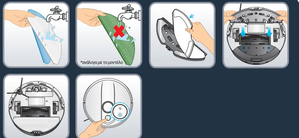
Βρέξτε το σφουγγαρόπανο με νερό πριν από τη χρήση. Εάν χρησιμοποιείτε το πράσινο σφουγγαρόπανο, μην το βρέχετε. Συνδέστε το σφουγγαρόπανο στο πανί σφουγγαρίσματος. Πάρτε το πανί σφουγγαρίσματος και κουμπώστε το στο πίσω μέρος του ρομπότ. Πιέστε το κουμπί λειτουργίας για να ξεκινήσετε την εργασία καθαρισμού και σφουγγαρίσματος.
