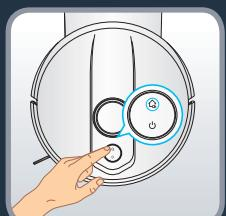
Uključite robota tako što ćete pritisnuti i držati dugme Pokreni dok se ne uključe svetla na robotu (~5 sekundi). Robota postavite od 20 do 50 cm ispred stанице. Pritisnите dugme „Početak“ i robot će se automatski priključiti na stanicu. (Nemojte ručno postavljati robota uz stanicu).
