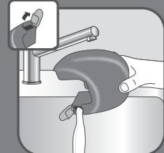
**SR** Zatvorite čep na ulazu rezervoara za vodu.
