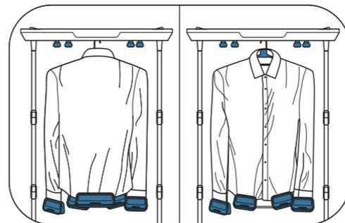
Pentru călcarea cu abur, așezați un straightener (clemă de tensiune) mare pe spatele cămășii, un straightener (clemă de tensiune) mică pe fiecare mânecă și două straighteners (cleme de tensiune) mici pe partea frontală a cămășii. În funcție de rezultate, ar putea fi nevoie să repositionați, să adăugați sau să scoateți greutatea pe/de pe îmbrăcăminte.
