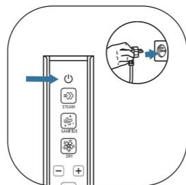
Schakel het apparaat uit en haal de stekker uit het stopcontact. Wacht een uur tot het apparaat volledig is afgekoeld.
