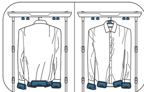
Τοποθετήστε ένα straightener (πρέσα ισιώματος) μεγάλου μεγέθους στο πίσω μέρος, ένα straightener μικρού μεγέθους σε κάθε μανίκι και δύο straighteners μικρού μεγέθους στο μπροστινό μέρος του πουκαμίσου.
