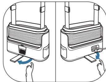
Izvalcite stabilizatorje na sprednji in zadnji strani izdelka Care For You.
