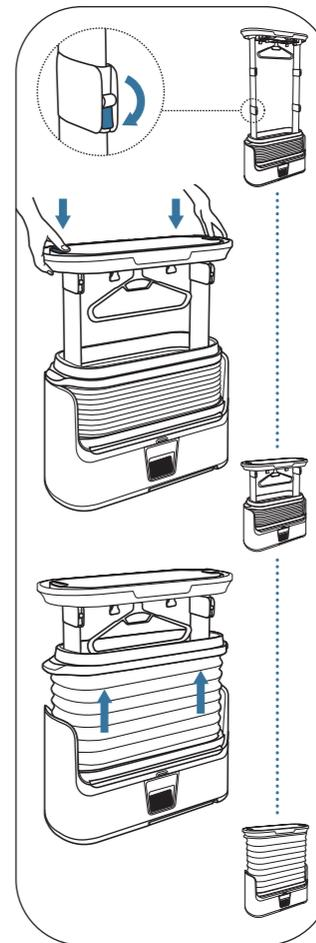
**Po izbiri:** Če želite izdelek zložiti, da ga shranite, sprostite zaklepe od zgoraj navzdol.
