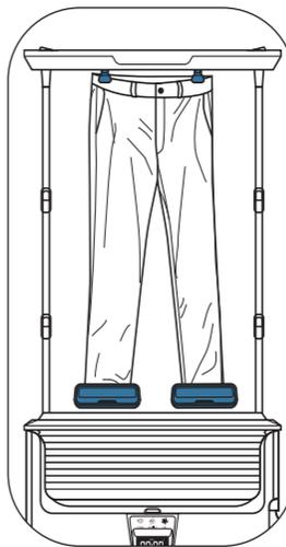
K zavěšení kalhot do zařízení Care For You použijte vestavěné straighteners (žehlicí svorky).
