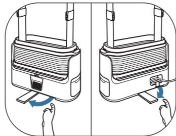
Trekk ut stabilisatorene foran og bak Care For You.
