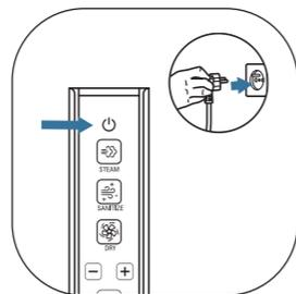
Isključite i iskopčajte aparat iz struje. Sačekajte jedan sat da se aparat potpuno ohladi.
