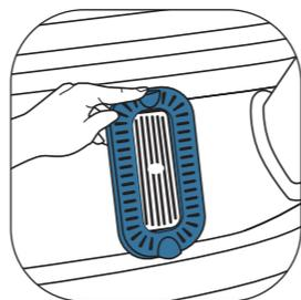
Scoateți prin ridicare raftul, îndepărtați filtrul și curățați cu un burete reziduurile existente.
