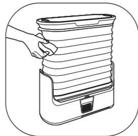
Reinigen Sie den Rollverschluss mit einem feuchten Tuch oder einem gut ausgewaschenen Schwamm.
