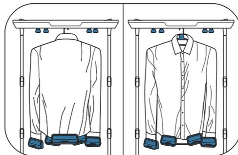
Za parenje stavite veliku straightener kopču na stražnju stranu majice, male straightener kopče na svaki rukav i dvije male straightener kopče na prednju stranu majice. Ovisno o rezultatima možda ćete morati razmjestiti utege po odjeći odnosno dodati ili ukloniti utege.
