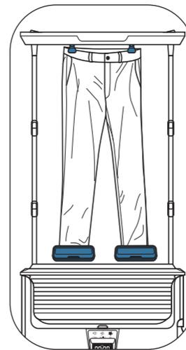
Utilizați straighteners (clemele de tensiune) încorporate pentru a vă agăța pantalonii în aparatul Care For You. Pentru călcarea cu abur, așezați un straightener (clemă de tensiune) mare în partea inferioară a fiecărui picior al pantalonilor.
