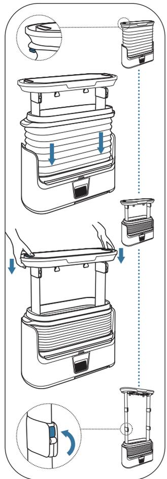
Lai aizslēgu nolaistu uz leju, pavelciet bloķēšanas/atbloķēšanas slēdzi.
