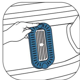
Ανασπώστε το ράφι, αφαιρέστε το φίλτρο και καθαρίστε τυχόν υπολείμματα με ένα σφουγγάρι.
