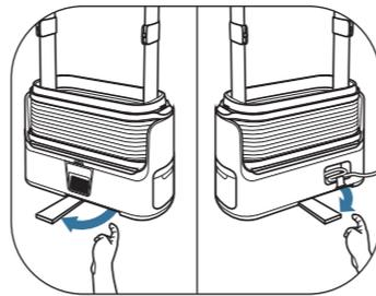
Izvucite stabilizatore na prednjem i stražnjem dijelu aparata Care For You.
