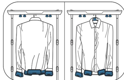
Aseta iso straightener (suoristusrauta) höyrytettävän paidan selkämukseen, pieni straightener (suoristusrauta) kumpaankin hihaan ja kaksi pientä straighteneria (suoristusrautoja) paidan etumukseen. Lopputuloksesta riippuen painot on ehkä asetettava toisin vaatteiden paalle tai painoja on lisattava tai vahennettava.
