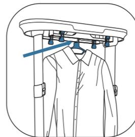
Așezați până la două cămăși pe un umerăș și agățați-le de bară. Dacă doriți să călcați cu abur o cămașă, închideți-i toți nasturii.
