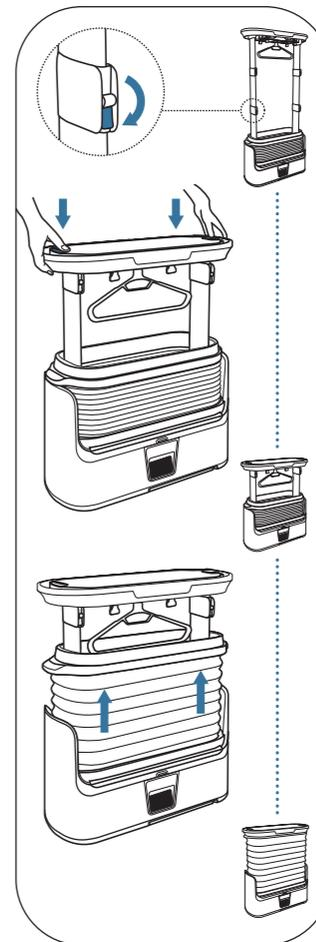
**Opțional:** Pentru a plia produsul pentru depozitare, eliberați elementele de prindere, începând de sus.
