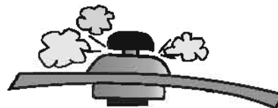
Figura 6. Válvula de seguridad dejando salir el vapor
