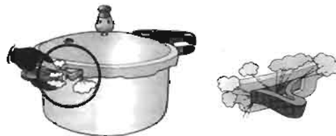
Figura 8. Ventana de seguridad de sobrepresión
