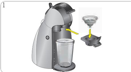
Spüleinsatz in Kapselhalter einsetzen. Kapselhalter in die Maschine einführen.
