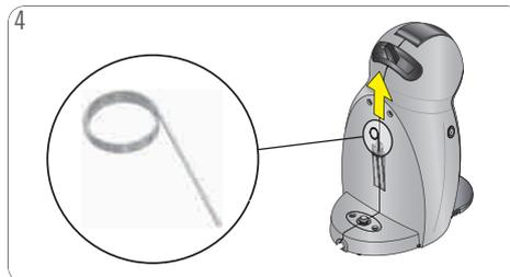
Arretierungsbügel schließen. Wasserbehälter entfernen und Reinigungsnadel entnehmen. **Nadel darf nicht in die Hände von Kindern gelangen!**
