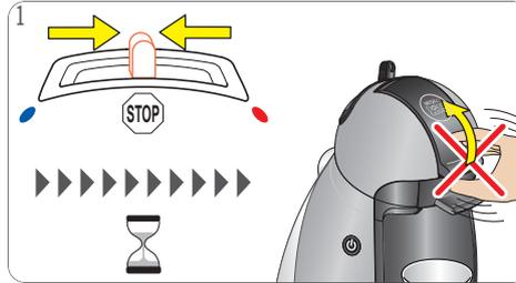
**Maschine nicht kippen oder auf den Kopf stellen!** Zum Unterbrechen der Getränkezubereitung Wahlhebel in Position "STOPP" bewegen. Arretierungsbügel nicht mit Gewalt öffnen. Die Maschine baut den Druck ab. 20 Minuten warten, bis der Druck abgebaut ist.
