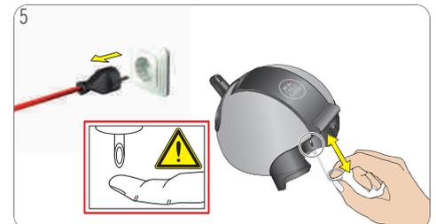
Maschine ausstecken! Abtropfgitter und Abtropfschale entfernen. Maschine für einfacheren Zugang zur Düse nach hinten kippen. Düse niemals mit dem Finger berühren! Düse mit Reinigungsnadel reinigen. Anweisungen in 8. „Entkalkung alle 3 – 4 Monate“ auf Seite 13 befolgen.
