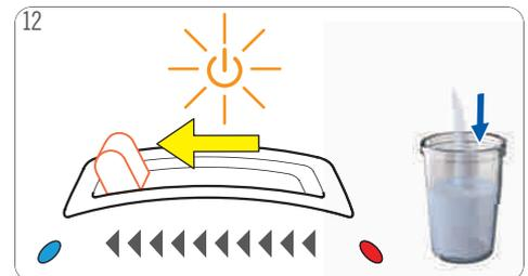
Wahlhebel in Position für "KALT" bewegen. Die Maschine beginnt zu spülen. Netzschalter blinkt orange.
