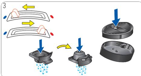
Maschine spülen: Anweisungen in 5. on page 1 befolgen. Kapselhalter auf beiden Seiten mit Spülmittel und Wasser reinigen. Abtropfschale mit Wasser abspülen und mit einer Bürste reinigen.
