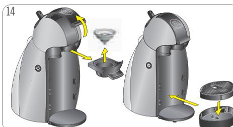
Arretierungsbügel öffnen. Kapselhalter herausziehen. Spüleinsetz entfernen. Kapselhalter auf beiden Seiten mit Wasser abspülen. Kapselhalter wieder einsetzen. Behälter leeren und reinigen. Abtropfgitter auf die Abtropfschale legen. Abtropfschale in der gewünschten Position an der Maschine anbringen.
