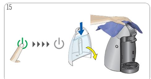
Maschine ausschalten. Wasserbehälter spülen und reinigen. Wasserbehälter mit frischem Trinkwasser füllen. Kapselhalter wieder in die Maschine einführen. Maschine mit einem weichen, feuchten Tuch reinigen. Anschließend mit einem weichen Tuch trocknen.
