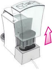
Wasserfilter entfernen. Verwijder het filter.
