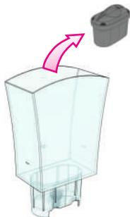
Wassertank mit einem handelsüblichen Entkalker und frischem Trinkwasser füllen. Wassertank wieder in das Gerät einsetzen.
