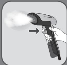
اترك الجهاز يعمل إلى أن يتم تفريغ خزان الماء بالكامل.
