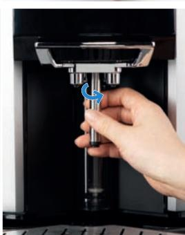
**! Предупреждение.** Существует опасность получить ожог при отворачивании сопла; оно может быть горячим (> 50°C).
