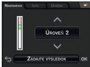
Ak sa prešťahujete alebo ak sa významnou mierou zmení kvalita vody, je potrebné znova zmeniť parametre tvrdosti vody.
