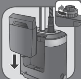
**ES** Enrosque por completo el tapón del depósito de agua y vuelva a colocar el depósito en el aparato.
