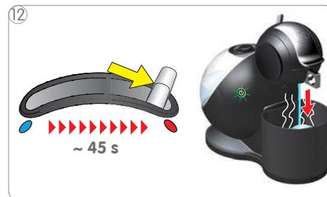
12 Colocar a alavanca selectora na posição "HOT" (QUENTE). A máquina inicia o ciclo de enxaguamento e o botão Ligar/Desligar pisca (verde).
