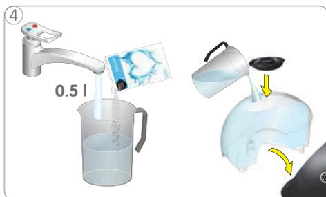
Misturar 0.5 litro de água potável com o conteúdo da saqueta de agente de descalcificação. Deitar a solução de descalcificação no reservatório de água e instalar o reservatório de água na máquina.
