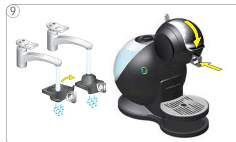
9 Enxaguar e secar o porta-cápsula (enxaguar com água de ambos os lados). Introduzir o porta-cápsula novamente na máquina. Delicie-se com a sua bebida!
