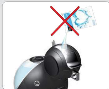
Evitar o contacto da solução de descalcificação com qualquer parte da máquina.
