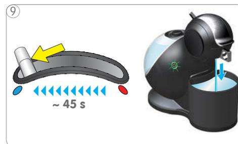
Colocar a alavanca selectora na posição "COLD" (FRIO). A máquina inicia o ciclo de enxaguamento e o botão Ligar/Desligar pisca (verde).
