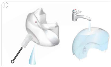
11 Lavar e enxaguar o reservatório de água. Encher o reservatório com água potável e instalar o reservatório na máquina.
