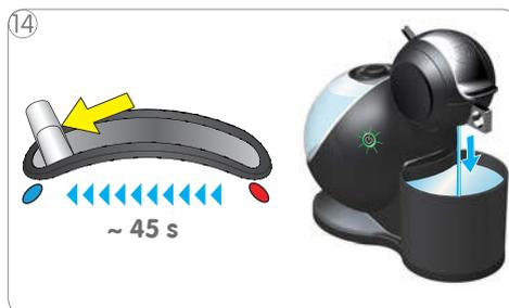
14 Colocar a alavanca selectora na posição "COLD" (FRIO). A máquina inicia o ciclo de enxaguamento e o botão Ligar/Desligar pisca (verde).
