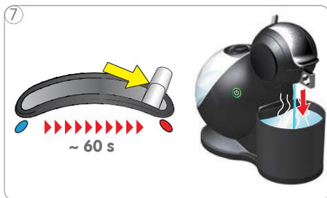
7 Colocar a alavanca selectora na posição "HOT" (QUENTE). A máquina inicia o ciclo de enxaguamento.
