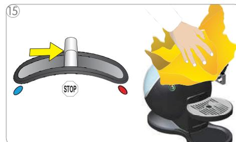
15 Após cerca de 45 segundos, colocar a alavanca selectora na posição "STOP". Encher o reservatório com água potável e instalar o reservatório na máquina. Limpar o exterior da máquina com um pano macio humedecido com água. Secar depois a máquina com um pano macio seco. Desligar a máquina.
