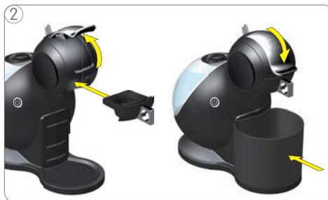
2 Levantar o manípulo e introduzir o porta-cápsula vazio (sem cápsula). Baixar o manípulo. Colocar o recipiente de cápsulas usadas por baixo do porta cápsulas
