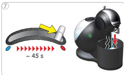
Colocar a alavanca selectora na posição "HOT" (QUENTE). A máquina inicia o ciclo de enxaguamento e o botão Ligar/Desligar pisca (verde).
