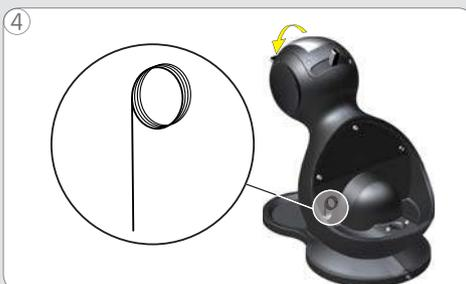
Retirar o reservatório de água e retirar a agulha de limpeza. Fechar o manípulo.
