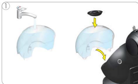
1 Lavar e enxaguar bem o reservatório de água. Encher o reservatório com água potável. Colocar a tampa e instalar o reservatório na máquina.
