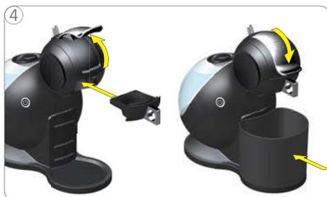
4 Abrir o manípulo e introduzir o porta-cápsula vazio (sem cápsula). Fechar o manípulo e instalar o recipiente de cápsulas.
