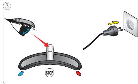
3 Verificar se a alavanca selectora se encontra na posição "STOP". Depois, ligar a ficha a uma tomada.
