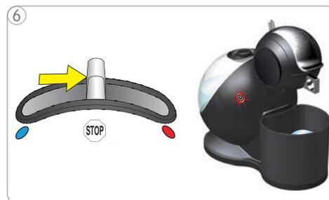
6 Após cerca de 60 segundos, voltar a colocar a alavanca selectora na posição "STOP". A máquina pára o ciclo de enxaguamento e o botão Ligar/Desligar pisca (vermelho) durante cerca de 5 segundos.
