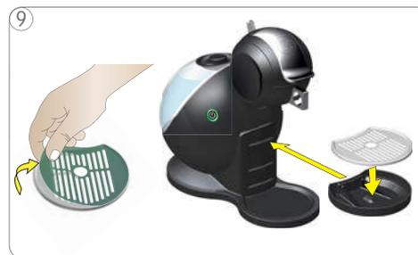
9 Retirar a película protectora da grelha da gaveta de recolha de pingos. Colocar a grelha sobre a gaveta de recolha de pingos. Colocar o conjunto, montado, na máquina.
