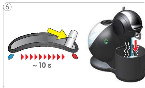
6 Colocar a alavanca selectora na posição "HOT" (QUENTE). A máquina inicia o ciclo de enxaguamento.
