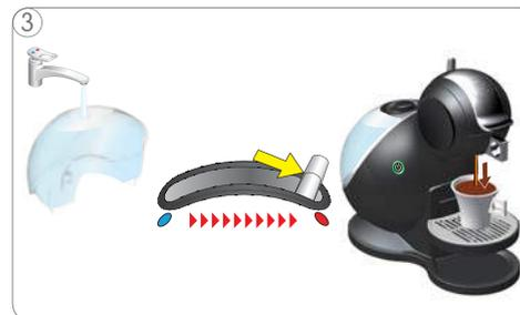
3 Verificar se existe água no reservatório: em caso negativo, encher o reservatório e colocar a alavanca na posição quente/frio para continuar a extracção da bebida; se o reservatório de água estiver cheio, proceder conforme indicado a seguir:
