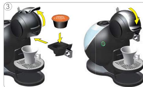
3 Levantar o manípulo e puxar o porta-cápsula para fora. Introduzir uma cápsula no porta-cápsula e introduzir novamente o porta-cápsula na máquina. Baixar o manípulo.
