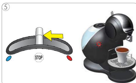
5 Após obter a quantidade de bebida desejada, voltar a colocar a alavanca selectora na posição "STOP". A máquina pára a extracção da bebida.
