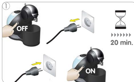
1 Desligar a máquina. Verificar se a cápsula se encontra bloqueada (ver a pág. 12). Desligar a ficha da tomada e aguardar 20 minutos. Depois, ligar novamente a ficha na tomada e ligar a máquina.
