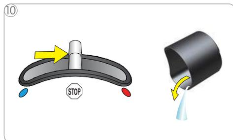
10 Após cerca de 45 segundos, colocar a alavanca selectora na posição "STOP". Esvaziar o recipiente de cápsulas usadas.
