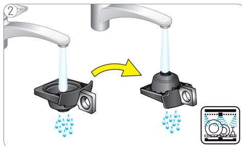
2 Enxaguar e secar o porta-cápsula (enxaguar com água de ambos os lados). O porta-cápsula pode também ser lavado na máquina de lavar a loiça.
