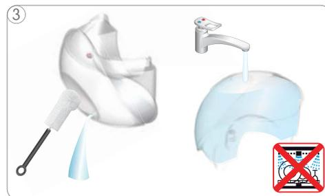
3 Lavar e enxaguar o reservatório de água. Encher depois o reservatório com água potável e instalar o reservatório na máquina. O reservatório de água NÃO deve ser lavado na máquina!
