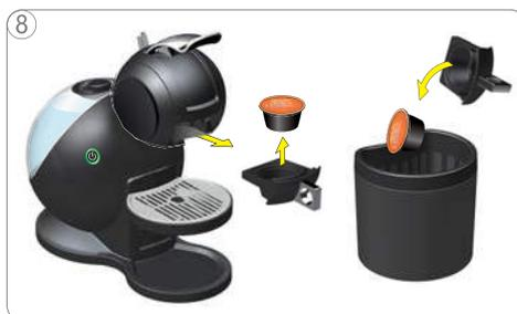
8 Puxar o porta-cápsula e retirar a cápsula usada. Colocar a cápsula usada no recipiente de cápsulas.
