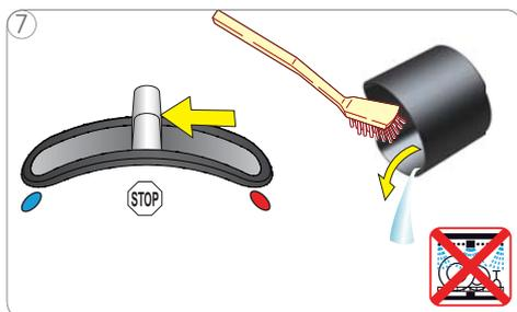
7 Após cerca de 10 segundos, colocar a alavanca selectora na posição "STOP". Esvaziar e limpar o recipiente de cápsulas usadas.
