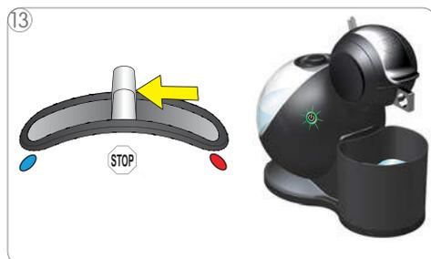
13 Após cerca de 45 segundos, colocar a alavanca selectora na posição "STOP".
