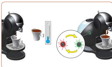
**Se a bebida sair gota a gota, ou se a temperatura da bebida for inferior ao normal, a máquina deve ser descalcificada.**
