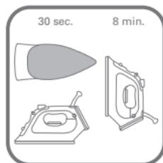
Si no mueva la plancha mientras está enchufada, un interruptor interno de seguridad la desconectará. La desconexión se producirá a los 8 minutos si se deja la plancha en posición vertical, o a los 30 segundos si se deja sobre su suela o volcada.
