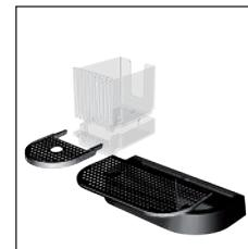
La unidad de mantenimiento puede desmontarse para facilitar su limpieza.
