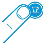
1. Drücken Sie die Lungotaste bei ausgeschalteter Maschine und halten Sie sie für 5 Sekunden gedrückt.
