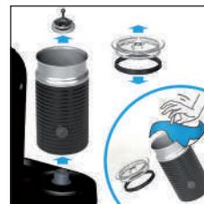
4. Reinig na elke bereiding. Gebruik alleen een zachte doek, geen borstel. De beker is waterdicht. Niet in de vaatwasser zetten.
