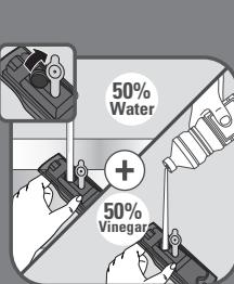
**NL** Anti-kalk functie kan worden uitgevoerd als u merkt dat de prestaties van uw apparaat afnemen. Voer deze handeling uit in een kamer met voldoende ventilatie.
