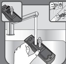
**PT** Encha o depósito da água com 100% de água e repita a operação até que o depósito da água fique completamente vazio, de modo a lavar o aparelho.
